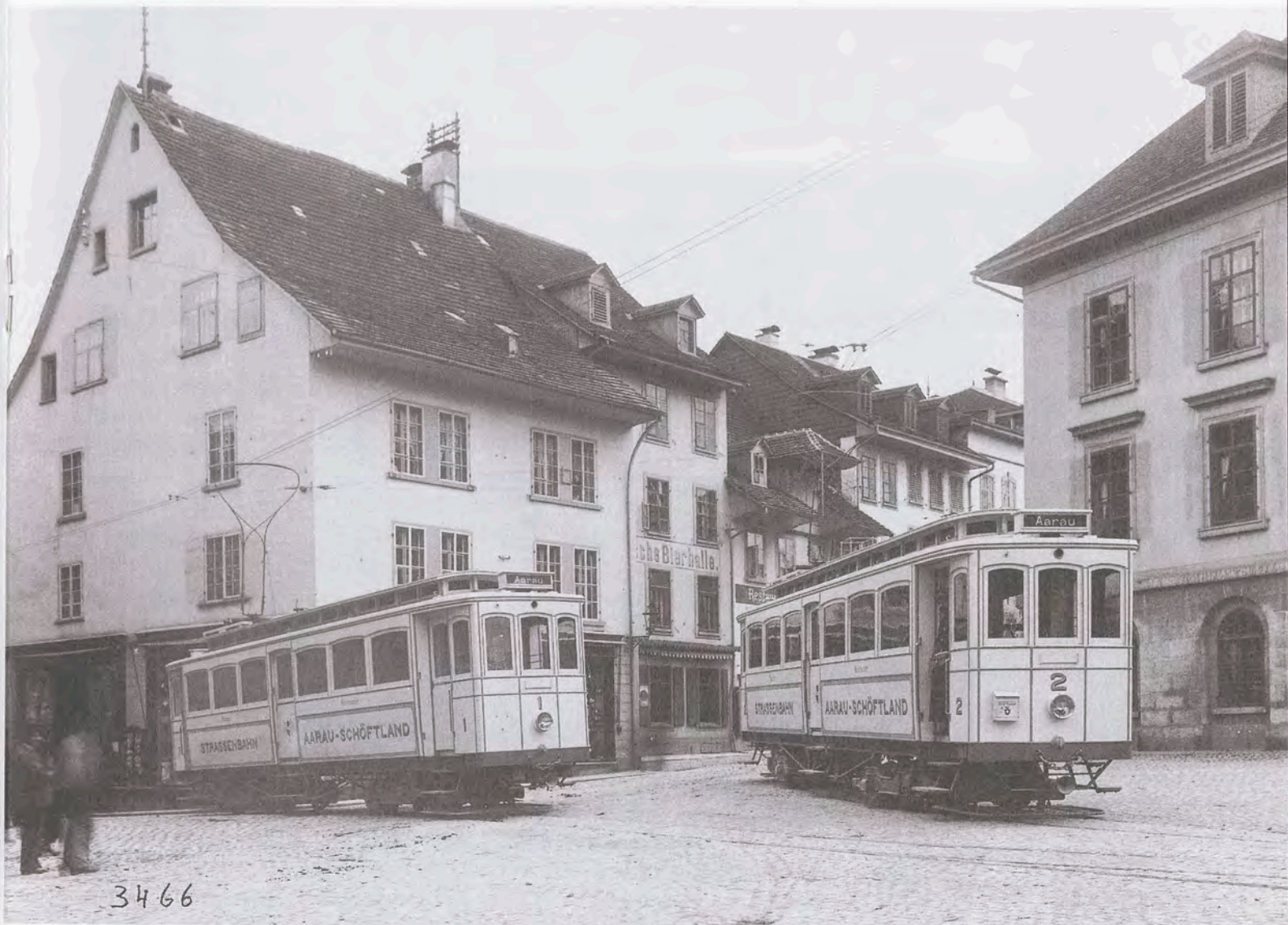
Auf dem Aargauerplatz beim Regierungsgebäude musste die Aarau-Schöftland-Bahn eine Spitzkehre machen. Aufnahme kurz nach der Eröffnung, 1902.
